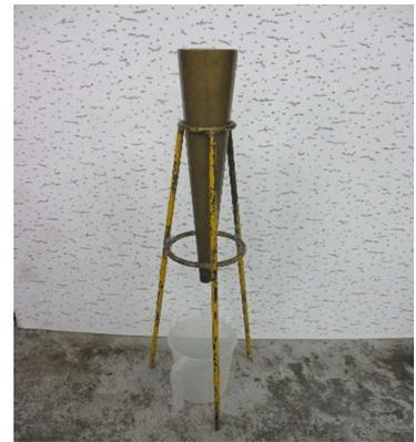
写真-1 J14 ロート試験器
